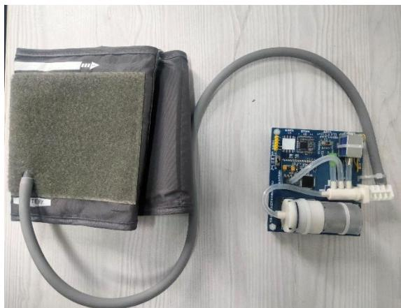
图 3-12 数字血压检测模块实物图
